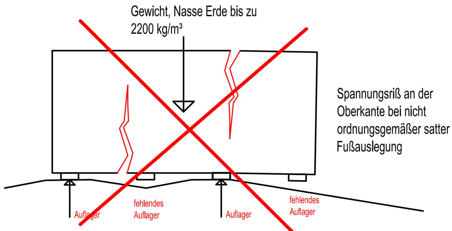
Wenn die Platten an den Oberkanten oder die Eckverbindungen im oberen Bereich Risse aufweisen und die Rissstelle rauh ist, ist den meisten Fällen eine schlechte Aufstellung die Ursache!
